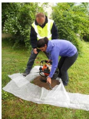
Photo 1 : Sondage et prélèvement de sol à la tarière thermique
