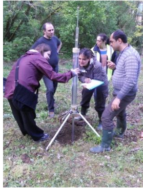
Photo 2 : essai de conductivité hydraulique au perméamètre de Guelph.
