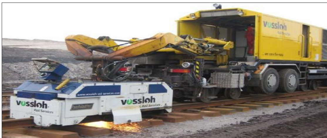
Figure 33. Unité de soudage mobile sur camion rail-route Vossloh
