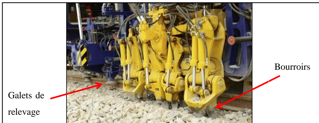
Figure 68. Représentation des galets de relevage et des bourroirs
