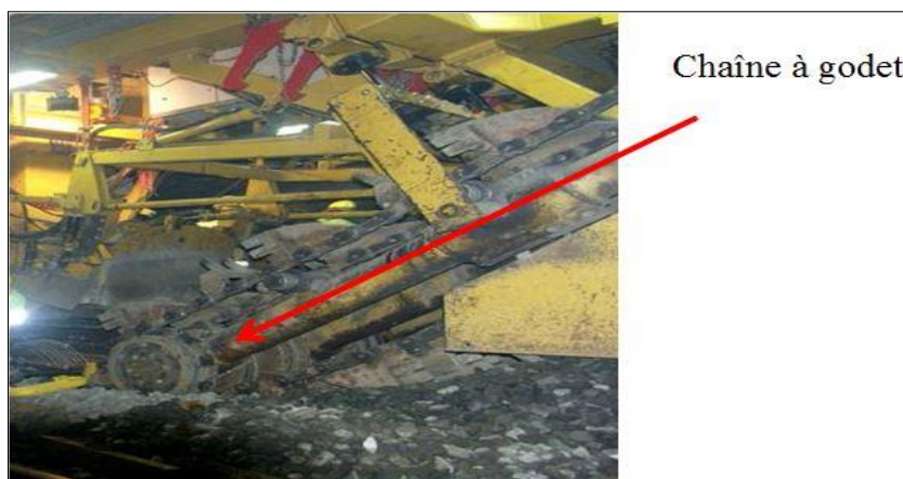
Figure 71. Photo d'une chaîne à godet et excavation longitudinale
