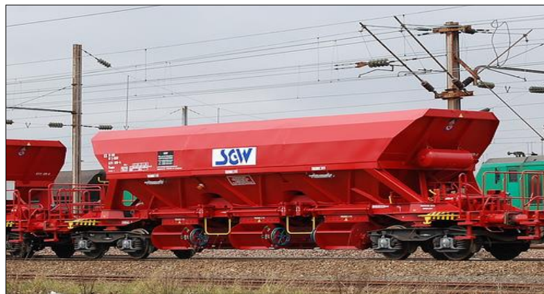
Figure 106. Photo de ballastière type BEX
