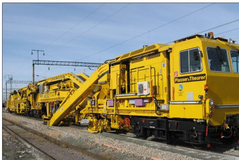
Figure 70. Photo d'une dégarnisseuse à chaîne PLASSER&THEURER
