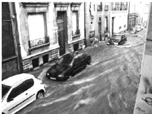
**Photo 2.1. Inondation en surface par engorgement du réseau d'assainissement**
